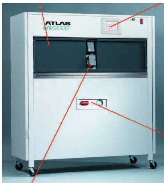
Fot. 1. Komora UV 2000 Atlas do prób starzeniowych materiałów
