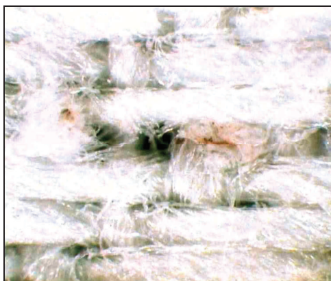
Zdjęcie 3. Katalityczny wpływ jonów żelaza na uszkodzenie włókna w procesie bielenia nadtlenkowego
