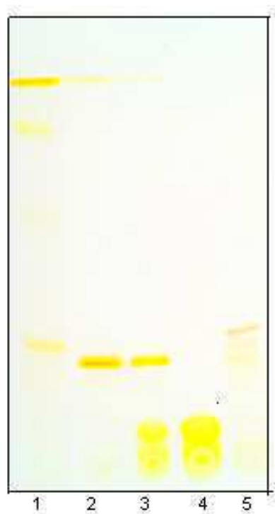
Rysunek 2: Płytkę TLC po rozwinięciu w układzie ksilen: kwas octowy (10:1 v/v). Plamy: 1-karoten, 2-annato, 3-próbka badana, 4-kurkumina, 5-ekstrakt z papryki.
