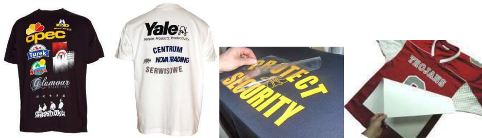
Fot. 26. Termotransfer plastizolami.
