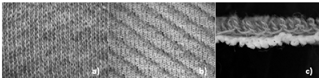
Zdjęcie 1. Rzeczywisty wygląd prawej (a) i lewej strony (b) oraz przekroju poprzecznego (c) dzianiny dwuwarstwowej reliefowej o przeznaczeniu odzieżowym (Wariant I - „PA/PES_L2/B”).
