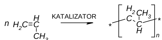
Rys. 1. Schemat reakcji otrzymywania polipropylenu n – stopień polimeryzacji
