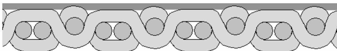
Wygląd wyrobu powlekanego pianą stabilną po suszeniu i kalandrowaniu
