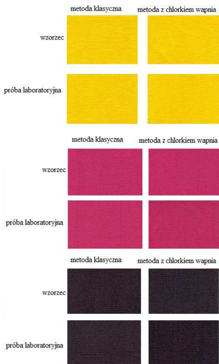
Rys. 9. Wybarwienia barwnikami wzorcowymi (Eriofast) i zsyntetyzowanymi.
