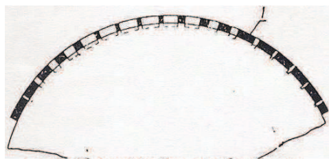
rys. 17. Obraz autotypijny rastra krzyżowego, skopiowany bezpośrednio na uczulonej powierzchni cylindra, bez użycia papieru pigmentowego, 1-koloid
