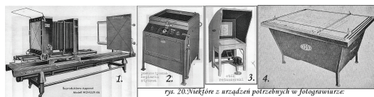
Fig. 20. Urządzenia potrzebne w fotografowaniu: 1. Kłama reprodukcyjna, 2. pneumatyczna kopiarka stykowa, 3. stół retuszujący podświetlany, 4. stół montażowy podświetlany
