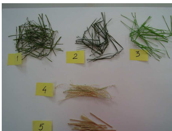
Rys. 3. Widok poszczególnych elementów sztucznej trawy
