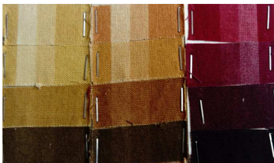
Rys. 23. Różny efekt płowienia wybarwień wykonanych naturalnym barwnikiem – od lewej Wau - Color, Fustic - Color i Coche - Color. Od góry wybarwienie bez utrwalania, utrwalane w kąpeli: z alunem, siarczanem miedzi i siarczanem żelaza
