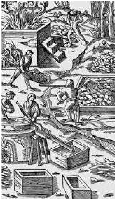
Wydobywanie i obróbka alunu
