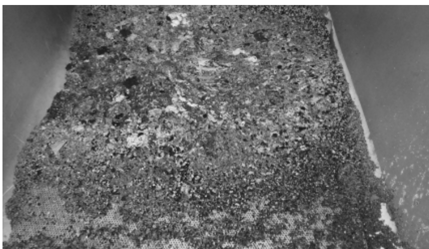
Rys. 5. Skratki powstające w procesie filtracji [ Zdjęcie własne].
