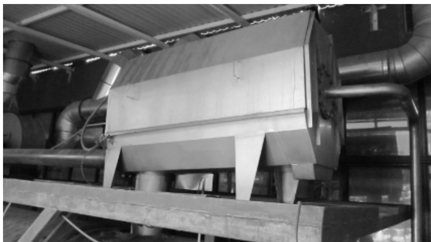
Rys. 4. Samoczyszczący filtr siatkowy, tzw. „łapacz bębnowy” firmy PFTechnology Sp. z o.o. [ Zdjęcie własne].
