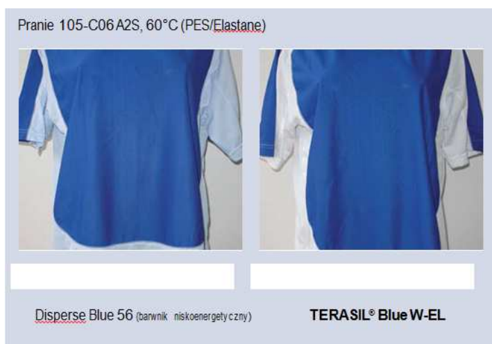
Rys 7. Zafarbowanie białych elementów koszuli po praniu użytkowym. Porównanie klasycznego barwnika zawieszinowego do Terasil® Blue W-EL.
