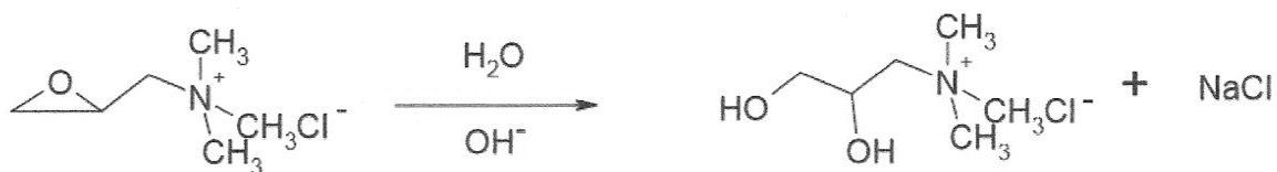
Rys. 10. Reakcja hydrolizy CHPTAC do chlorku 2,3 dihydroksytrimetyloamoniowego
