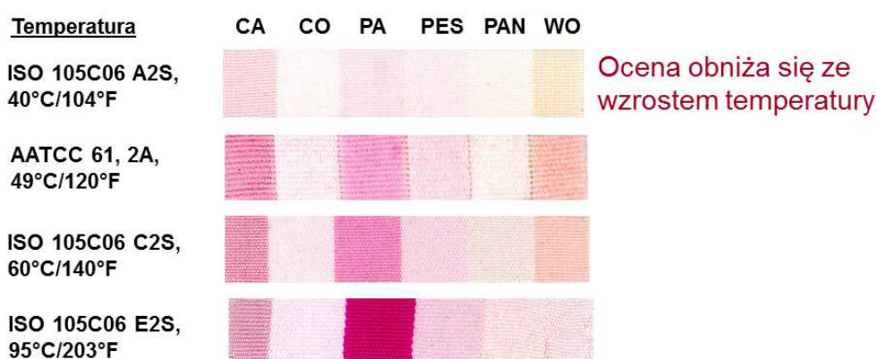
Rys 2. pokazuje jak pogarszają się odporności wybarwień w zależności od temperatury prowadzenia testu i tkaniny towarzyszącej (taśma wielowłókienna).
