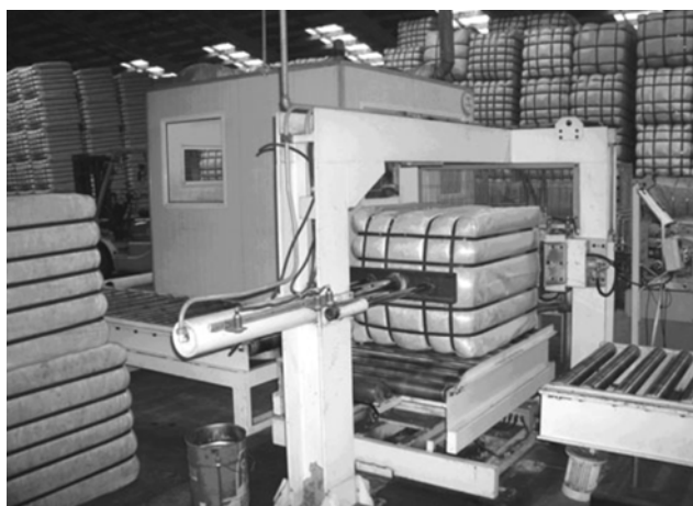
Urządzenie do pobierania próbek ze środka beli
