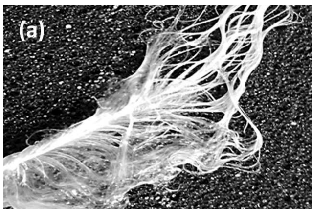
Rys 4. Test zwilżalności piór puchowych a) pióro niemodyfikowane b) pióro z nałożoną cienką warstwą polimeru pp-HMDSN (zapożyczone z [10])
