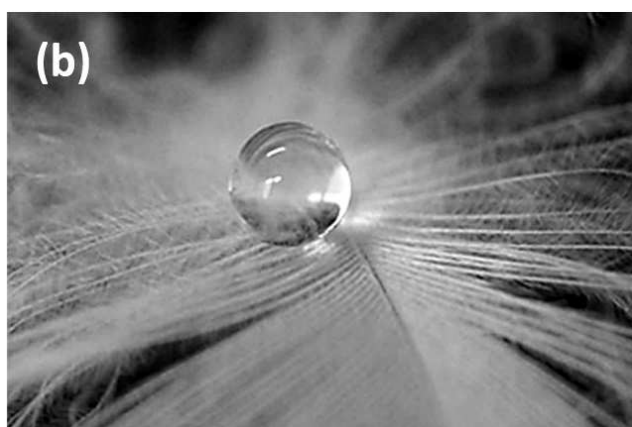
Rys 4. Test zwilżalności piór puchowych a) pióro niemodyfikowane b) pióro z nałożoną cienką warstwą polimeru pp-HMDSN (zapożyczone z [10])
