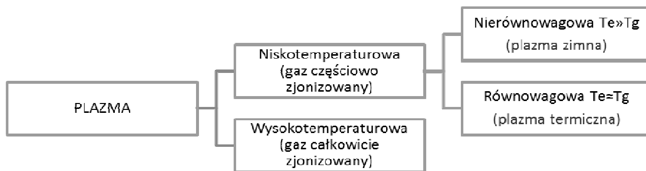
Rys.1. Schemat podziału plazmy: T_e – temp. elektronów, T_g – temp. jonów i cząsteczek obojętnych (zaadaptowane z [4]).
