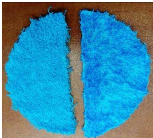
Rys. 6. Zdjęcie oceny uszkodzenia włókna bawełny w wyniku działania czynników utleniających. Po lewej stronie- z ręcznika nowego, po prawej z ręcznika pranego.
