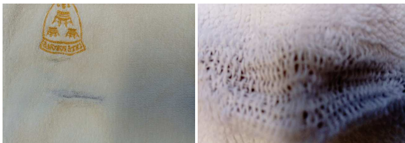
Rys. 4. Zdjęcie dziur w ręcznikach przesłanych do analizy. Po lewej stronie fragment ręcznika z całkowitym przzerwaniem nitów, po prawej inny ręcznik z przzerwaniem tylko nici osnowy zasadniczej i miejscowym rozciągnięciem osnowy pętelkowej.
