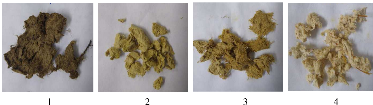
Rys. 4. Zdjęcia włókien celulozowych uzyskanych z biomasy celulozowej metodą eksplozyjno-parową poddanych 1- tylko alkalicznej obróbce wstępnej, 2 – tylko jednokrotnemu procesowi bielenia w kąpeli zawierającej nadtlenek wodoru, 3 - alkalicznej obróbce wstępnej i jednokrotnemu procesowi bielenia w kąpeli zawierającej nadtlenek wodoru, 4 - alkalicznej obróbce wstępnej i dwukrotnemu procesowi bielenia w kąpeli zawierającej nadtlenek wodoru
