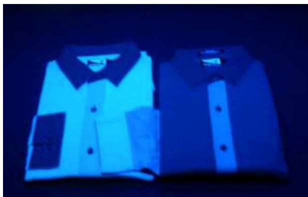
Rys. 13. Chociaż te koszule w świetle dziennym wydają się, że nie wykazują istotnych różnic kolorystycznych, po włączeniu światła UV można zobaczyć, że poszczególne elementy tych koszul są w rzeczywistości parami metamerycznymi
