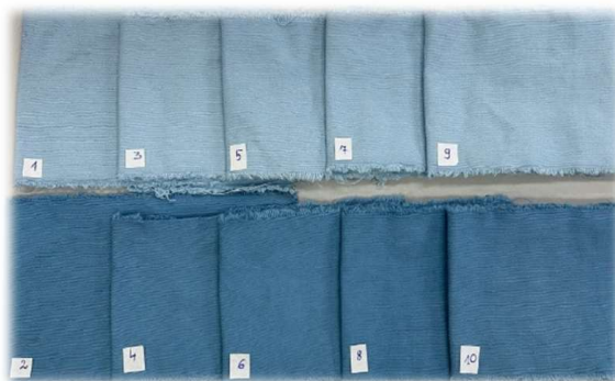
Fot. 1. Zdjęcie tkanin bawełnianych po procesie barwienia przy zastosowaniu wody demineralizowanej i oczyszczonych ścieków (próbka nr 1 i nr 2 - próbki referencyjne wybarwione na wodzie demineralizowanej, próbki 3-10 - wybarwione na oczyszczonych ściekach. Warunki barwienia podano w Tab. 1.)
